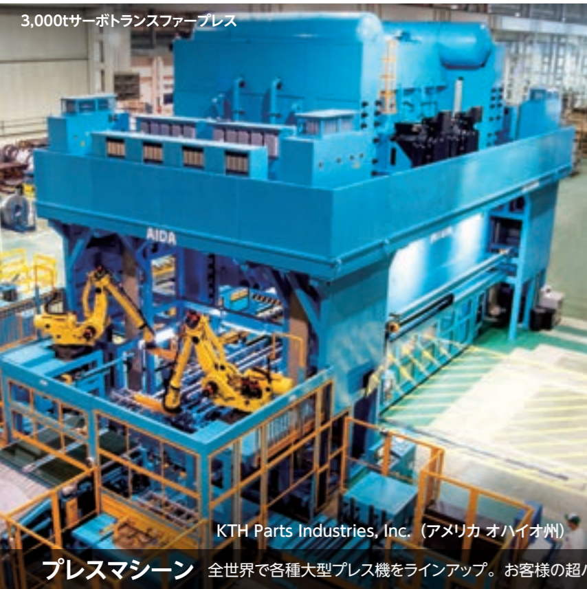
手前：800t プログレッシブプレス 奥：1,500t トランスファープレス (2台)
